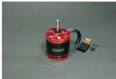
QP0022 モーター BLS4025-740 BLS4025-740 MOTOR ●14,500 KV740 LiPo 8Sに最適、6Sの場合 は、低回転スケールフライト に最適。 (6S時は、24T以上のプーリ推奨) 重量約330g
